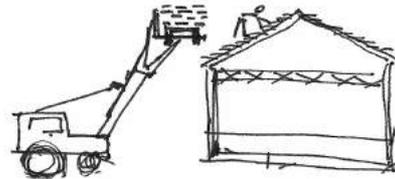
Possibilité: échafaudage classique ou location de nacelle permettant une mise en palette directement au moment de la dépose. La mise en place d'un mode de déconstruction est tout l'enjeu du plan d'expérimentation que nous souhaitons mettre en place.
